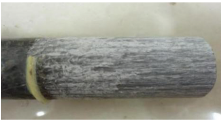
图 7 GFRP 管材胶接破坏图
