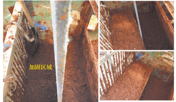
图 3 试验土样填筑
