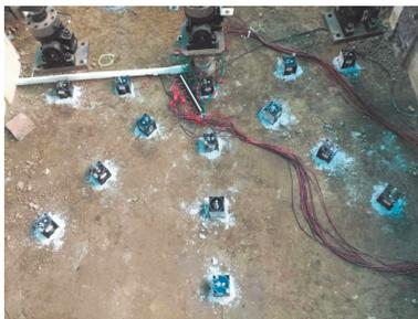
图 3 速度传感器布置现场图
