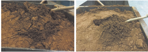
图 4 根系横向拉拔土体破坏面形态
