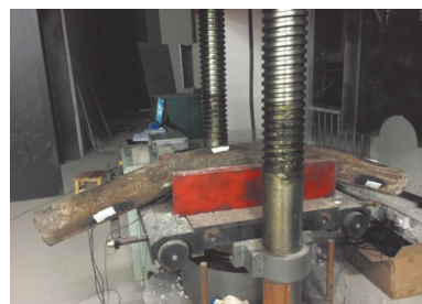
图9 钢管+H型钢桩破坏形态
