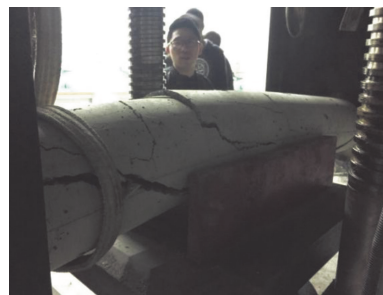
图8 桩心配筋桩破坏形态
