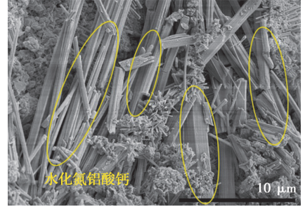
图 11 钙矾石被侵蚀转变为 NO 3 -AFm
