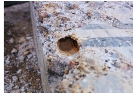
图 12 骨料被硝酸侵蚀
