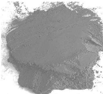
图 3 垃圾焚烧底渣再生微粉
