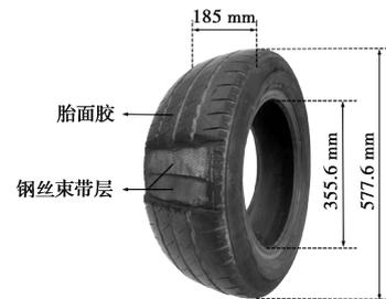
图 2 轮胎的构造尺寸
