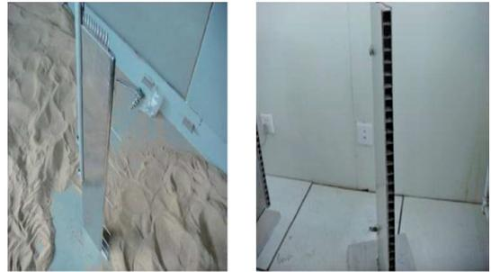
(a) 风速廓线测试仪 (b) 梯度集沙测试仪
