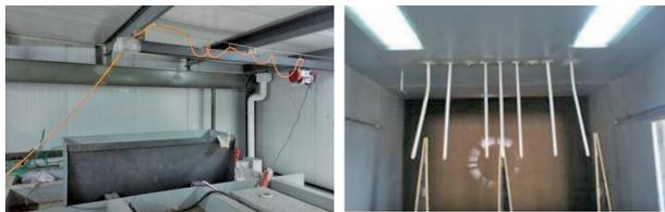
(a) 顶部漏沙槽装置 (b) 内部上侧漏沙孔
