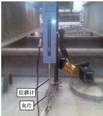
图 3 植筋滑移测量
