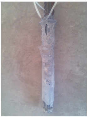
图 5 锥体-粘结混合破坏 图 6 锥体-粘结混合破坏过程 Fig. 5 Compound failure Fig. 6 Failure process of compound failure
