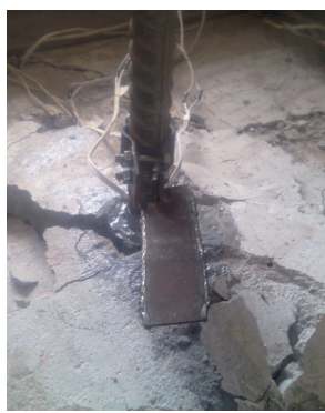
图 5 锥体-粘结混合破坏 图 6 锥体-粘结混合破坏过程 Fig. 5 Compound failure Fig. 6 Failure process of compound failure
