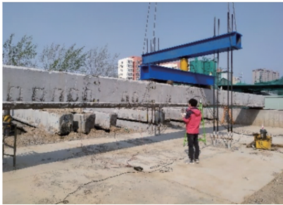
图 9 极限承载能力试验
