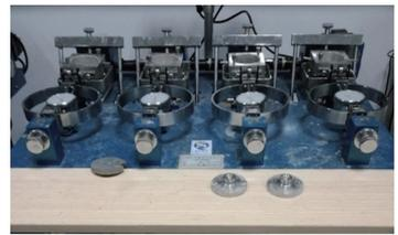
图1 ZJ型应变控制式直剪仪
