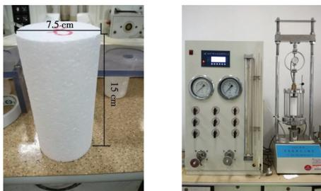
图 4 试样及三轴仪装置示意图
