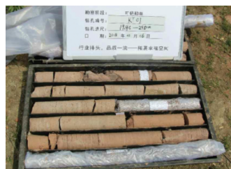
图 1 研究区中等风化泥岩钻孔岩芯
