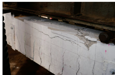
(a) SL-6-U2 适筋破坏
