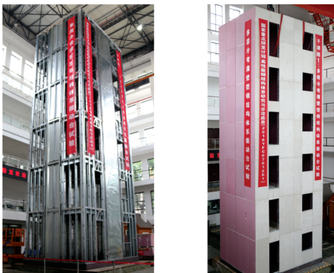
图 3 振动台试验模型
