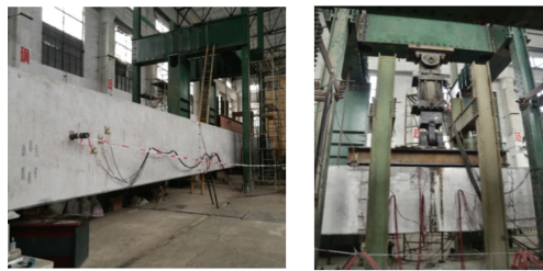
(a) 轨道梁全景 (b) 轨道梁疲劳加载
