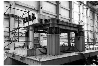
图7 独柱桥墩筒支梁桥模型 [38]
