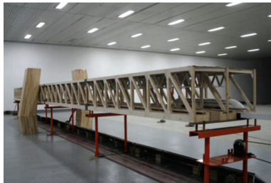
图 3 桥塔遮蔽区移动列车气动特性风洞试验 [40]
