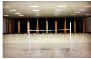
图 4 流线型断面气动导纳风洞试验 [42]
