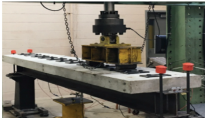
图 13 装配式螺栓剪力键 [27]
