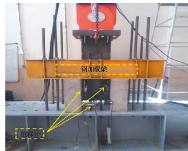
图 7 螺栓剪力键反复加载试验 [17]
