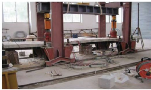
(a) 试件试验现场变形照片
