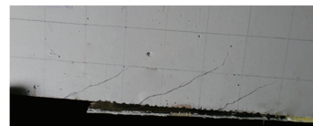
(c) S35(2)-4-A 板端剥离破坏
