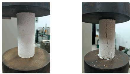
(a) 胶结完好的砂柱 (b) 砂柱整体剪切破坏
