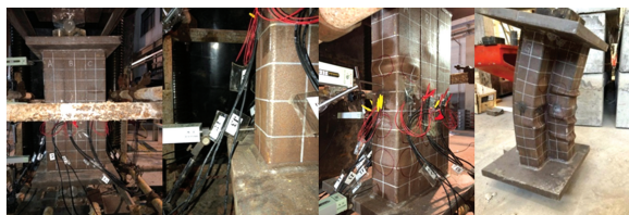
图 7 短柱试件 T-1 破坏过程
