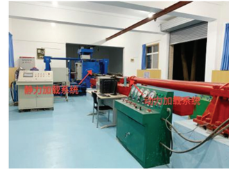
图 2 真三轴静动综合加载试验系统
