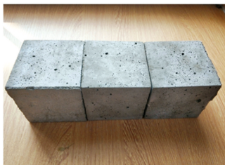
图 1 混凝土抗压试件形貌
