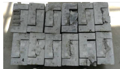
图 4 破坏后的试件
