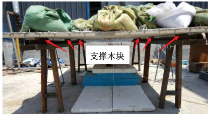
图 4 试件加载和支撑照片
