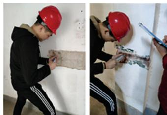
图 1 砖、砂浆强度检测
