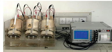
(a) 氯离子扩散系数测试设备
