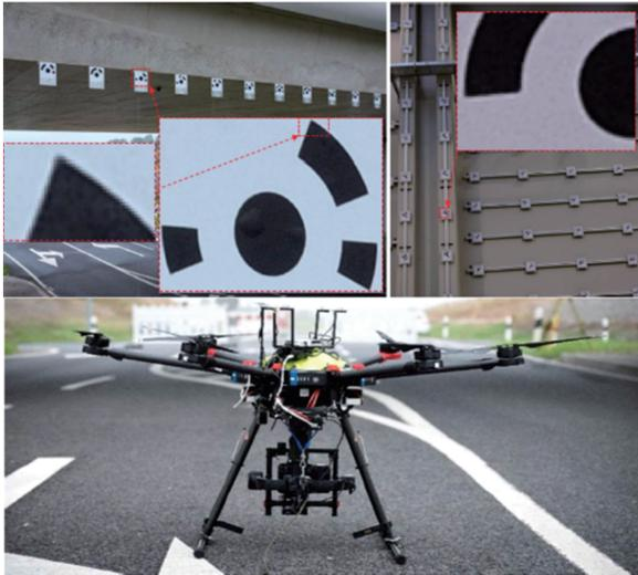
图 9 定位目标及测试无人机<sup>[40]</sup>
