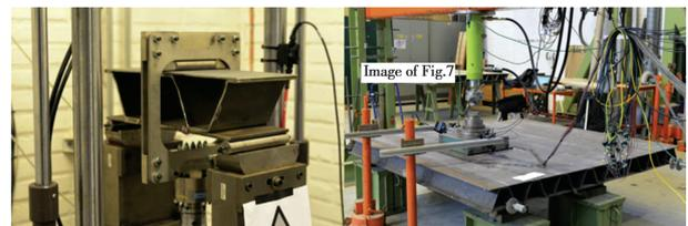
图 16 波纹夹芯板钢桥面及其疲劳试验<sup>[44-46]</sup>
