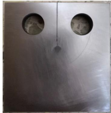
图 11 桥梁耐候钢 Q345qDNH 的 CT 试件<sup>[22]</sup>
