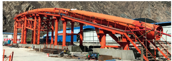
图 3 拱节段环境温度场现场测试
