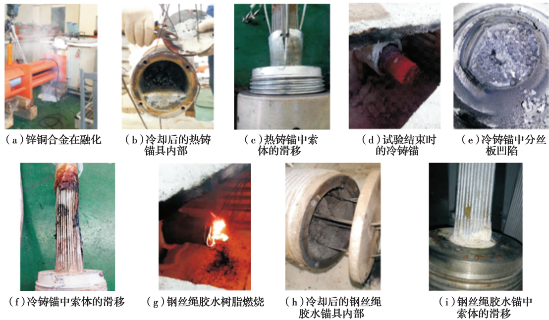
图 13 锚头破坏形态
