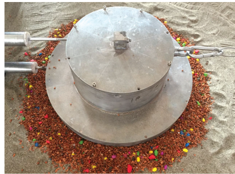
图4 砾石垫层隔震模型 [44]
