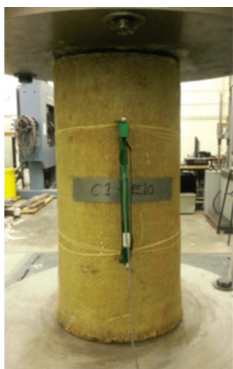
图 6 FRP 约束木桩 [25]
