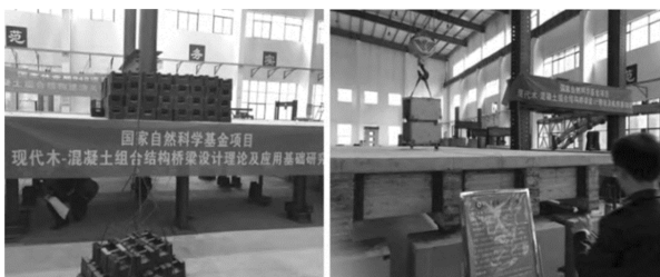
图 8 TCC 梁桥静力试验 [29]
