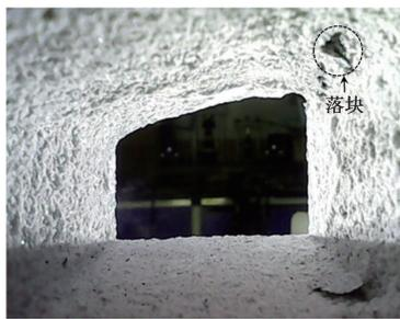
图 8 不含结构面隧洞模型的落块现象
