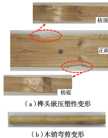
图 5 试件 T1 破坏形态
