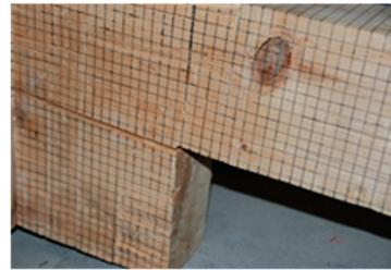
图 8 木纤维顺纹撕裂破坏
