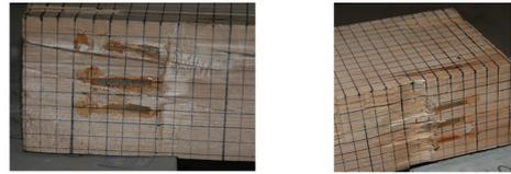
(a) 榫头木材挤压正立面 (b) 榫头木材挤压侧面视角
