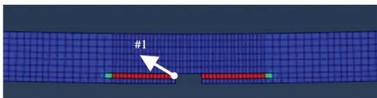
图8 底部缺口残损木梁有限元模型的剪切损伤发展和演化
