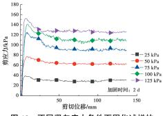
图 10 不同竖向应力条件下固化试样的 剪应力-剪切位移曲线
