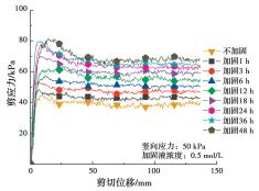
图 8 不同加固时间条件下钙质砂试样的 剪应力-剪切位移曲线
