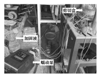
图 4 钙质砂试样的固化过程
