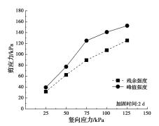
图 11 不同竖向应力条件下固化试样的峰值强度 及残余强度对比图
