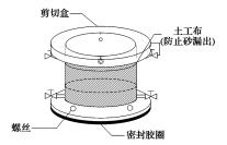
图 2 改造后的模具示意图
