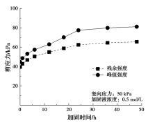
图 9 不同加固时间条件下钙质砂试样的峰值强度 及残余强度对比图
