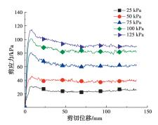
图 12 未加固钙质砂试样的剪应力—剪切位移曲线
