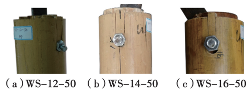
图 7 试件破坏现象
