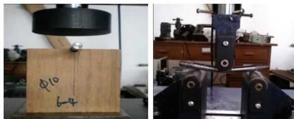
图1 重组竹半孔销槽承压和螺栓抗弯强度试验<sup>[18]</sup>
