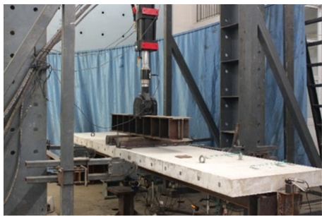
图6 加载装置
