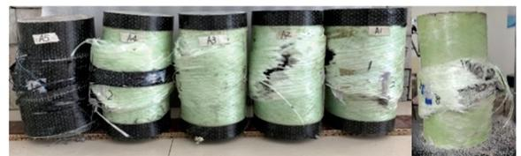
图5 试件最终破坏形态
