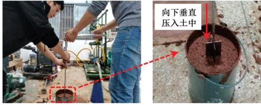
图 13 复合地层改良渣土十字板剪切试验
