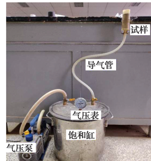
图 3 污染试验装置
