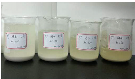
图2 MICP 水溶液试验
