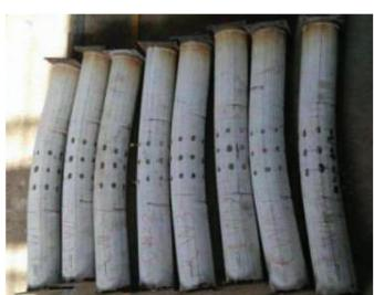
图 5 试件破坏形态
