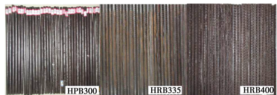
图 3 通过加速锈蚀试验得到的锈蚀钢筋
