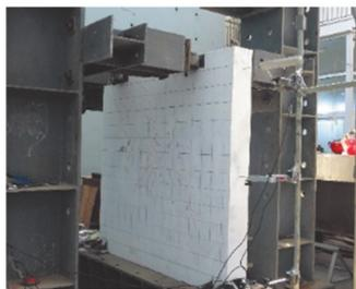
图 3 加载装置
