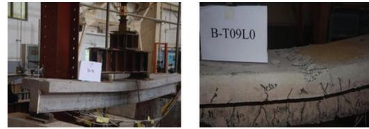
(a) 静载装置 (b) 梁破坏图
