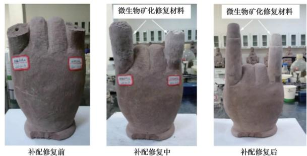
图2 基于微生物加固技术的石质文物补配修复试样
